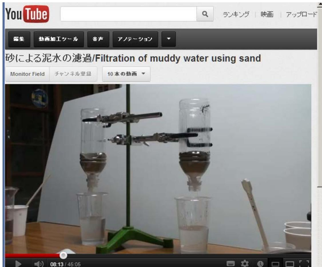
泥水は砂の層を通り抜けて透明になって出てくる。放射性セシウムのほとんどは粘土粒子に強く吸着(固定)されているので、セシウムだけが水中に溶け出ることはない。
